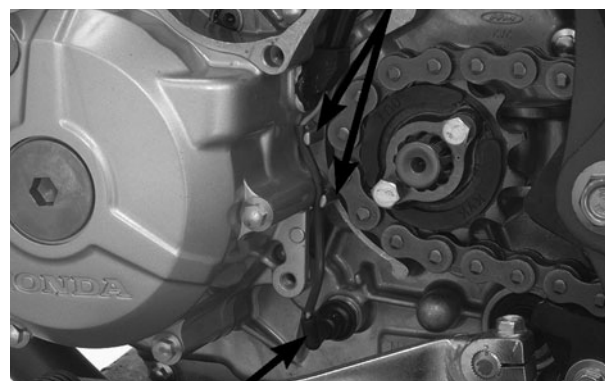
CONECTOR DO INTERRUPTOR DE PONTO MORTO EIXO
