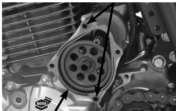
JUNTA TAMPA DA ENGRENAGEM REDUTORA
